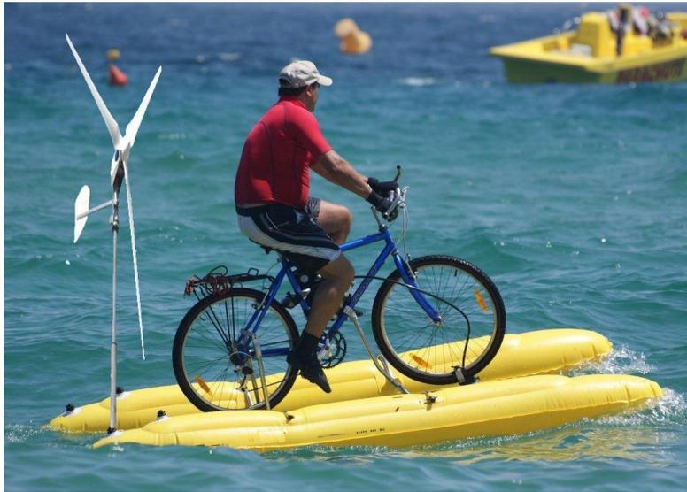
**Le modèle « récup »**, qui, comme son nom l'indique, est constitué par un pédalo traditionnel sur lequel on a installé une éolienne également traditionnelle, issue des constructions de nos aïeux (souvent dédiées au pompage de l'eau des puits – n'oublions pas que jusque dans les années 50, l'eau courante n'était pas la règle sur nos communes-). Le principal reproche que l'on peut faire à ce modèle est l'absence de protection autour de l'hélice, qui pose un problème de sécurité pour les usagers.
